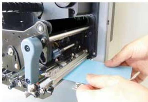
8 顺时针转动打印头锁定杆①，解开打印头。
